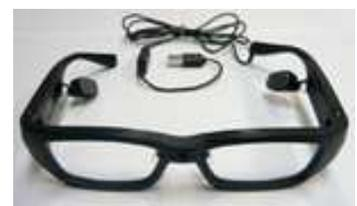
「メガネ型WEBカメラデバイス」はメガネにWEBカメラとマイク、骨伝導スピーカーがついており、ノートパソコンやタブレットに接続することで着用者の見たままの映像を遠隔地に伝送することができます。通信設備の被害状況の映像を災害対策本部等へリアルタイムに共有することにより、設備復旧計画の検討や現地への迅速かつ的確な指示にも役立てることができます。メガネ型WEBカメラデバイスは着用中でも両手が使えるので、被災地など足元が悪い状況でも着用者の作業効率を下げることはありません。
