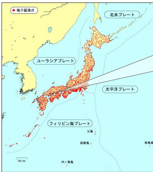
図-1 電子基準点配置図
