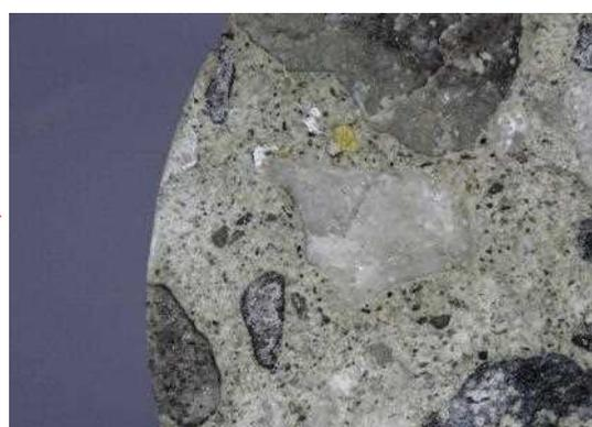
写真IV-2-14 参考:アルカリ骨材反応の
