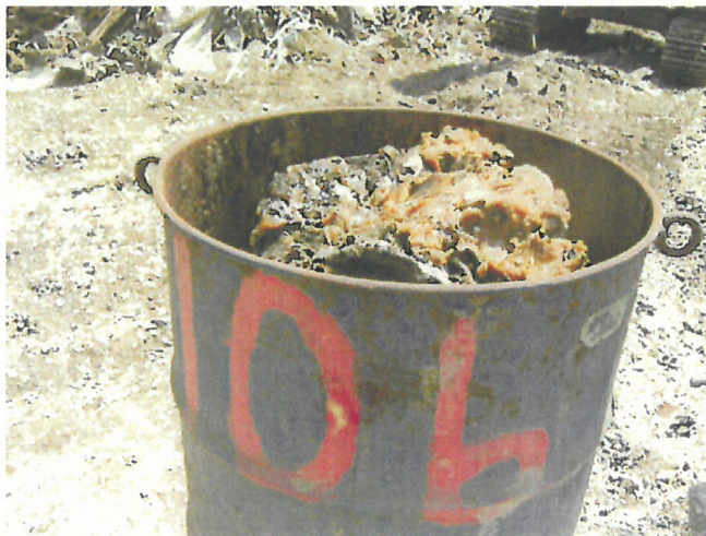
写真6 2重ドラム缶内への保管 (この後、密閉する)
