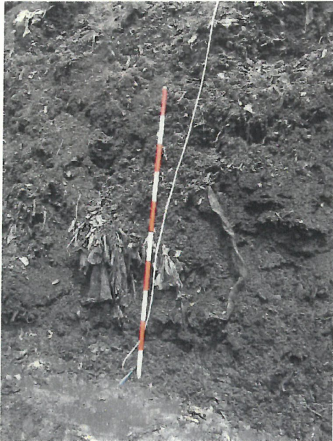
図4 GH-2地点 燃え殻混じりシュレッダーダスト層 TP+9.1m~+5.5m 廃棄物層と直下土壌の間から浸出水があった。
