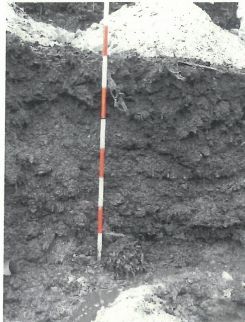
図5 GH-2地点 燃え殻混じりシュレッダーダスト層 (赤色塗料混じり) TP+5.5m~+4.2m
