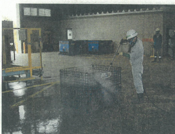
図5 網パレットに入れて高圧洗浄
