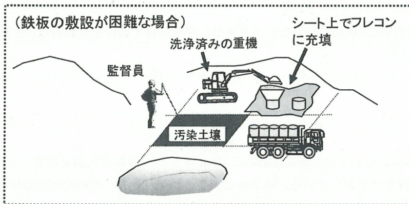
図2 廃棄物層直下汚染土壌の掘削・除去イメージ
