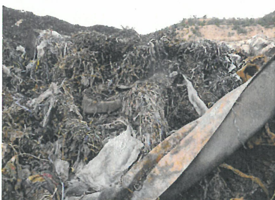
写真3 掘削されたラガーロープ (古紙を束ねたプラスチックバンド等を製紙 過程で番線に絡ませて取り除いたもの)
