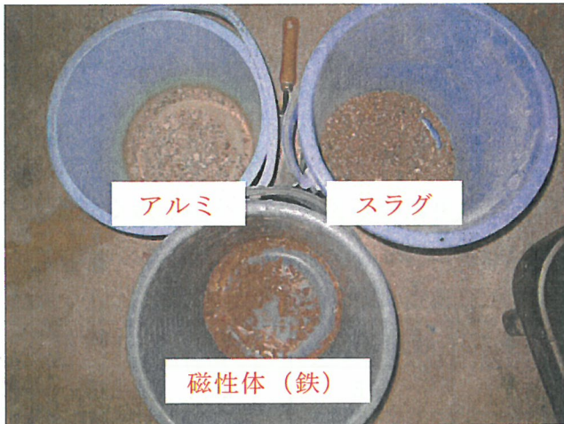
左の写真は選別後の試料。左上がアルミ、右上がスラグ、下が磁性体である。右の写真は水で濡らしたアルミ屑での選別試験中の写真。
