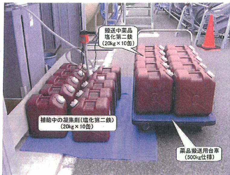
写真 1 「凝集剤(塩化第二鉄)運搬状況」
