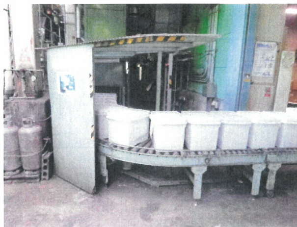
②低濃度 PCB 廃棄物（ペール缶）のロータリーキルンへの投入
