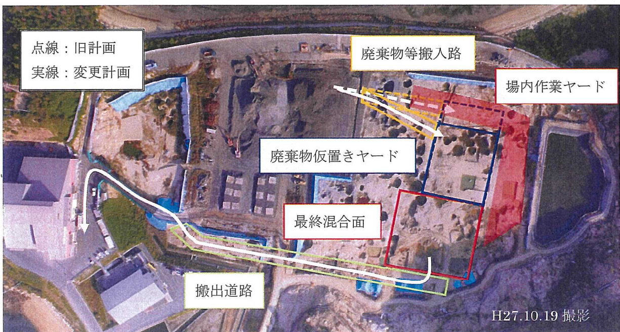
写真4 仮置きヤードの縮小と廃棄物等搬入路の法線変更
