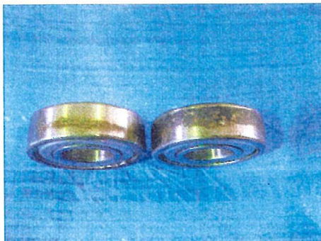
写真6 モーターベアリング摩耗
