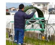
トンネル支柱打込み機
