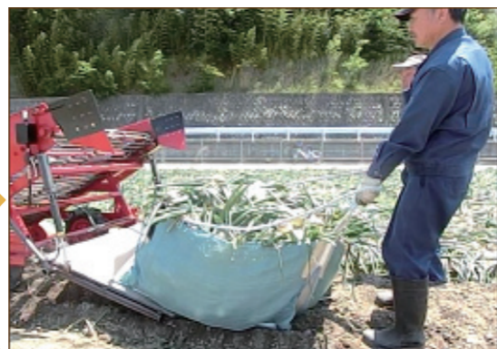
作業機を前進させ荷台から降ろす。
