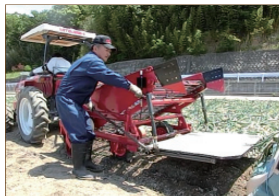
荷台を上げて油圧をロックする。
