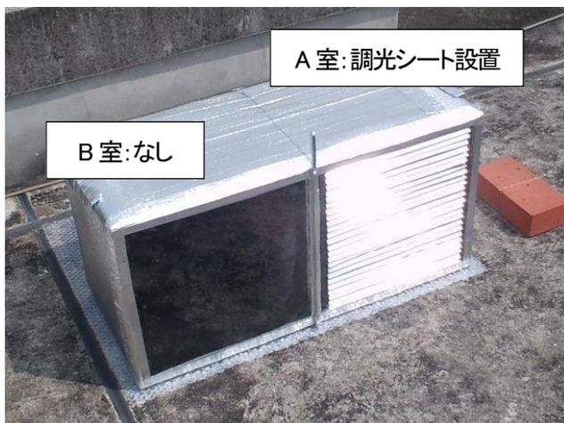
図5 A室に調光シートを設置した効果比較装置
