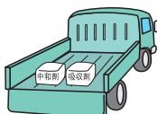
運搬事故時に対応するため、あらかじめトラックの荷台に中和剤や吸収剤を積んでおく。
