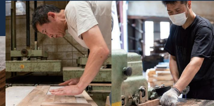
製材の粉をブラシで落とし、空間を空けて積み上げ、防虫処理を施し、木口に割れ止めを塗布、自然乾燥と人工乾燥で材を仕上げる。外材を入荷して家具を作るとの違い大変な手間がかかる。
