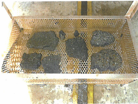
写真 1 洗浄試験後のアスファルトがら
