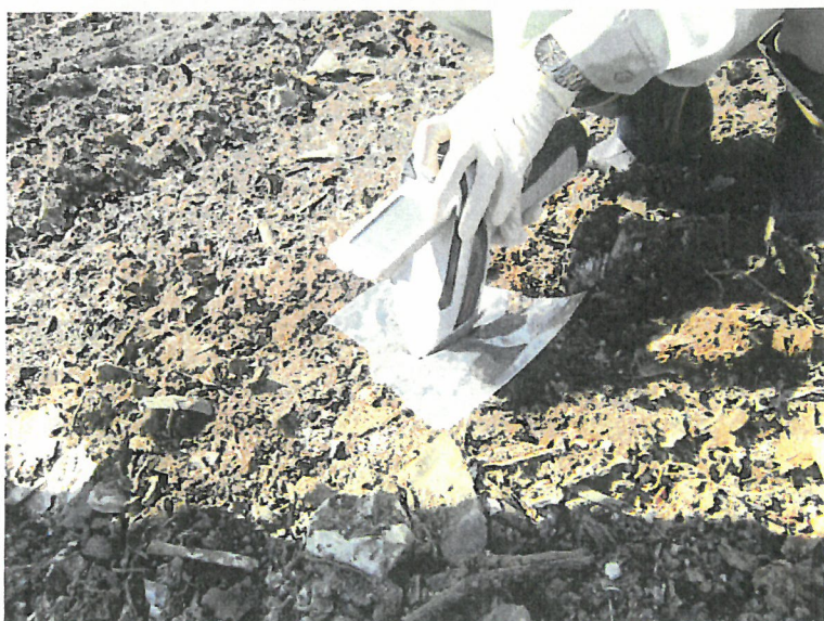
写真 10/28に行った携帯型蛍光X線分析装置による測定の様子
