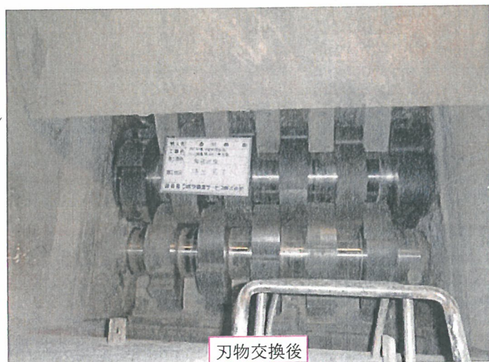
図 2.2 粗破砕機の交換部品 (刃物、オイルシール)
