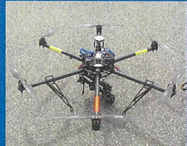
機体は特注品の 6プロペラタイプのドローン
