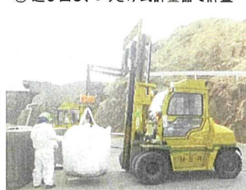
⑤ 運び出し、つりさげ式計量器で計量
