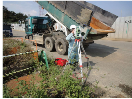
写真 3-5-3-8 トータルステーションによる放射観測
