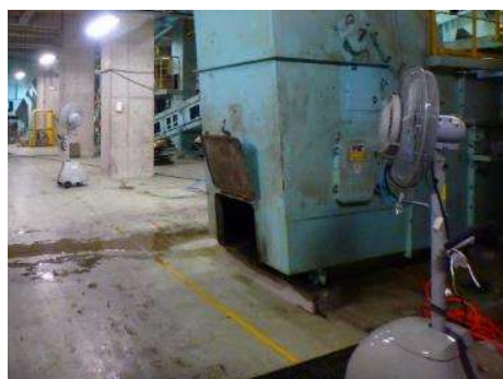
写真6-3-1-2 ミストファンを用いた管理区域内の湿潤化
