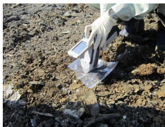
写真Ⅲ-3-2 携帯型蛍光 X 線分析装置による測定の様子 (2)
