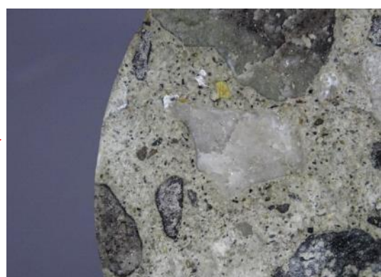
写真IV-2-14 参考:アルカリ骨材反応の 特徴的な状況(4)
