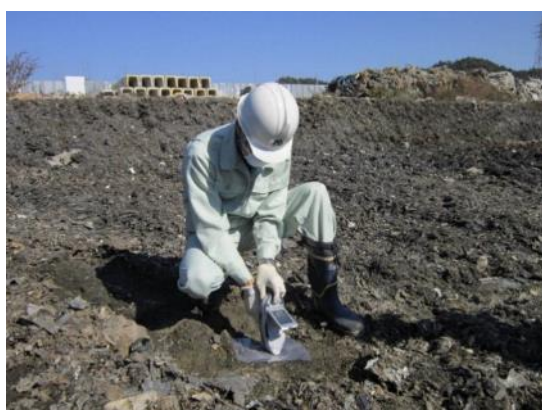
写真Ⅲ-3-1 携帯型蛍光 X 線分析装置による測定の様子 (1)
