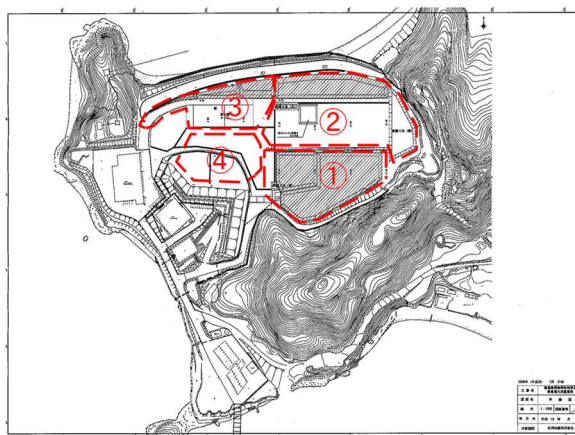
図 3-1-2-3-2 掘削計画の二巡目
