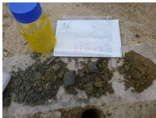
写真 3-1-2-2-5 土壌サンプリング状況
