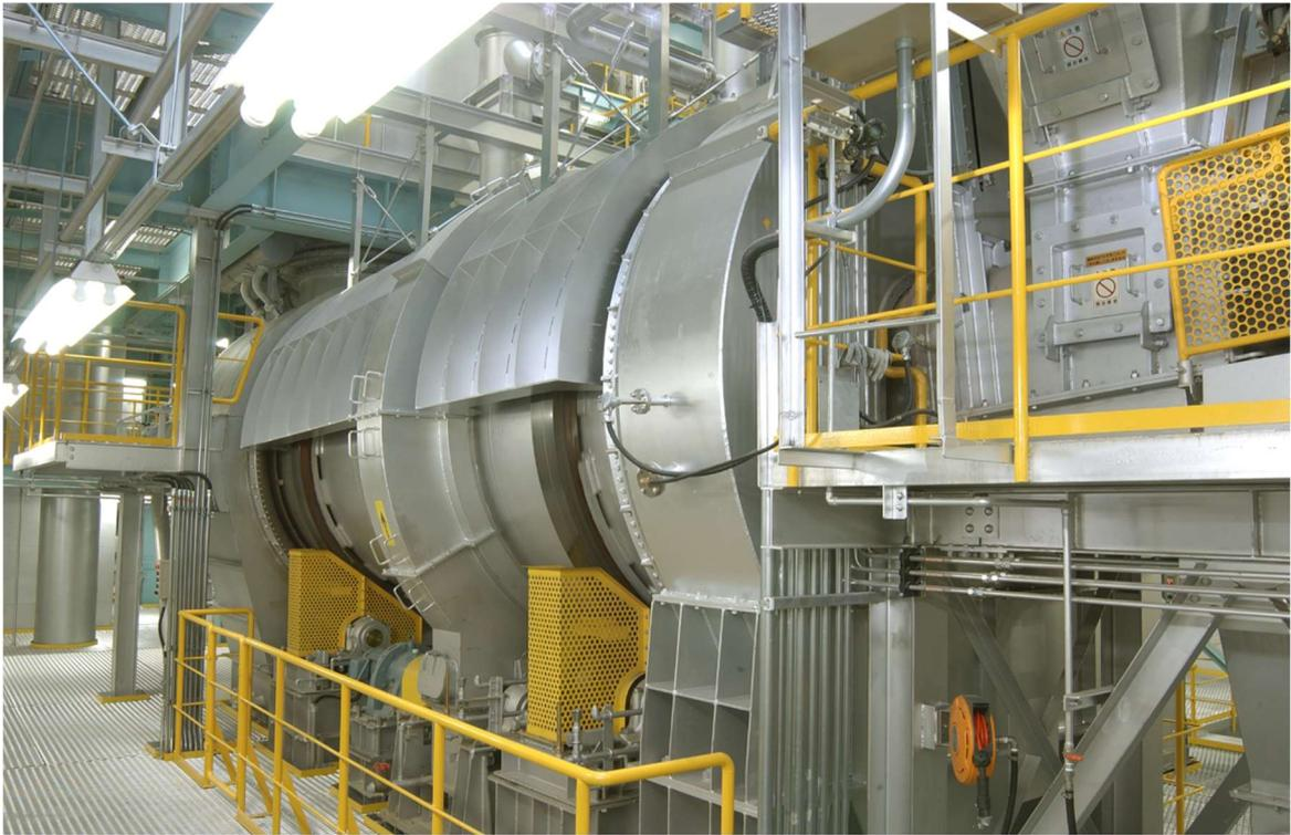
写真 7-5-30 中間処理施設 ロータリーキルン炉
