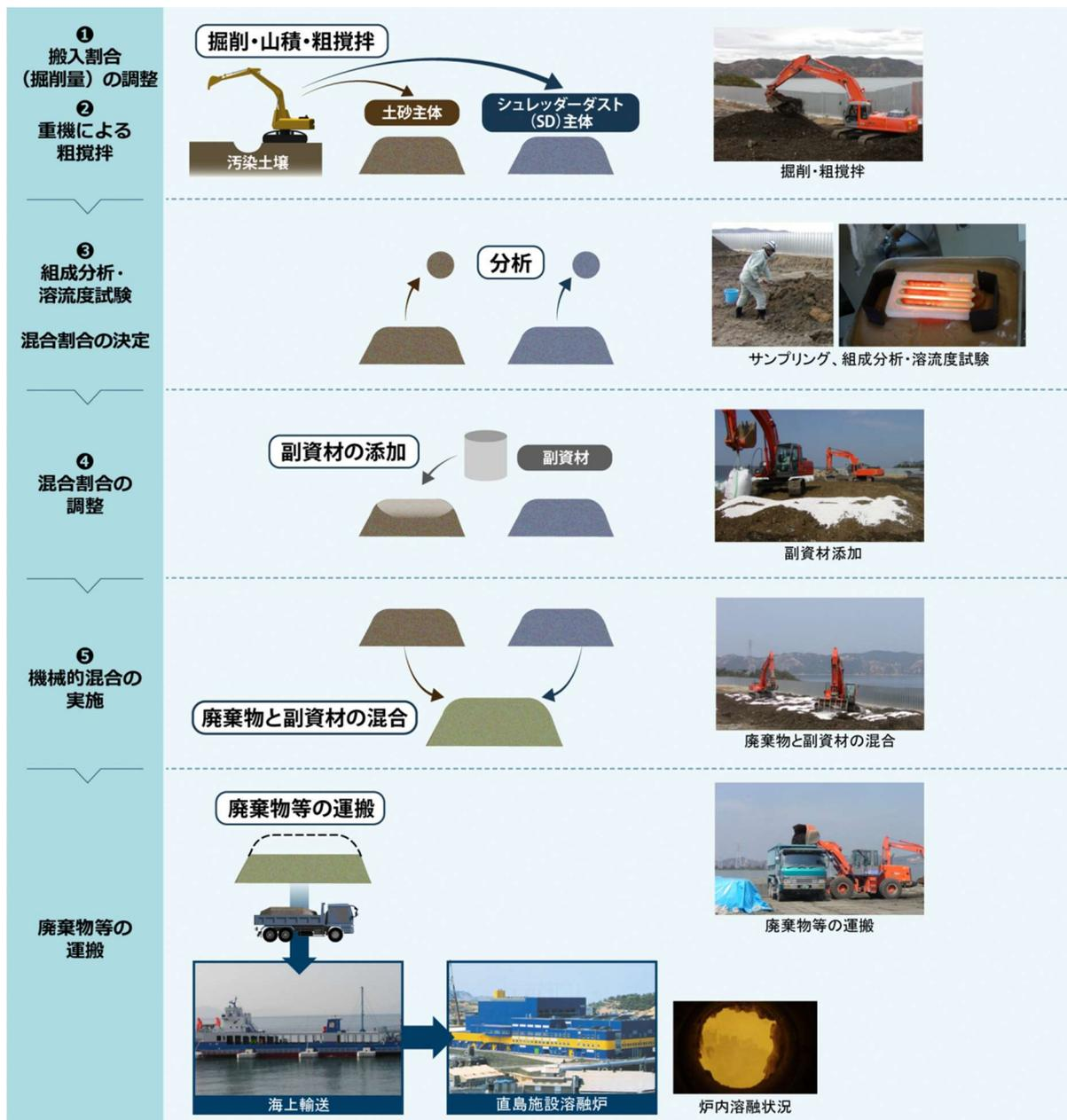
図 4-2-1-2 豊島廃棄物等の掘削・混合・運搬の流れ
