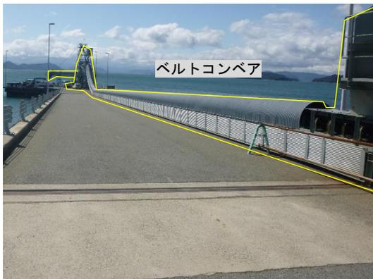
写真 1 ベルトコンベア（陸側）
