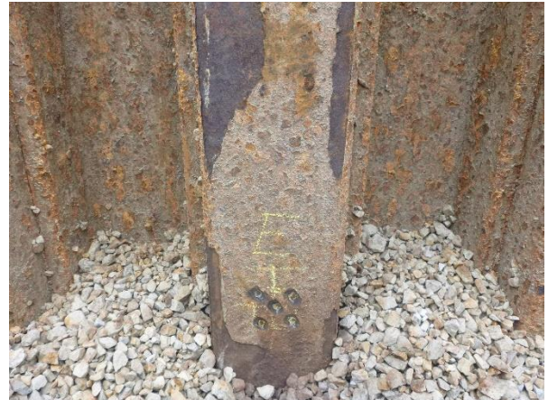
写真10 肉厚測定箇所-研磨後 (E 測線付近)
