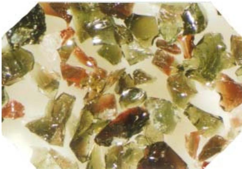
廃棄物等を高温で焼却・溶融すると、溶けて液状になります。これを水で冷却し、固化させた後、破碎機で細かい砂状にしたものが溶融スラグです。
