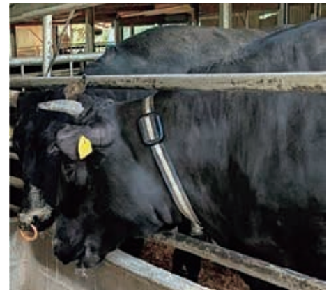
スマート機器 (牛の首に装着したICTセンサー)
