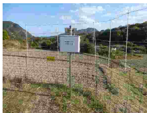
電気柵監視システム
