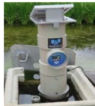
多機能型自動給水栓 （稲作の水管理を自動化・遠隔操作化）
