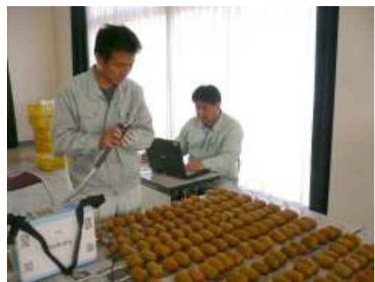
非破壊糖度計によるキウイの糖度調査
