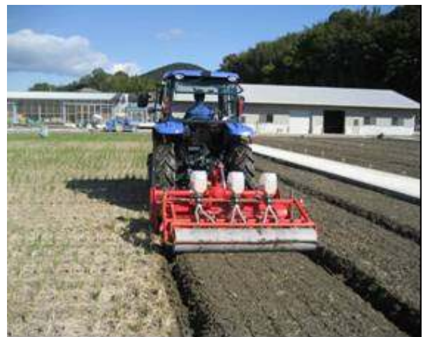
写真2 逆転ロータリによる畦立でドリル播種 (香川農試、平成23年度)
