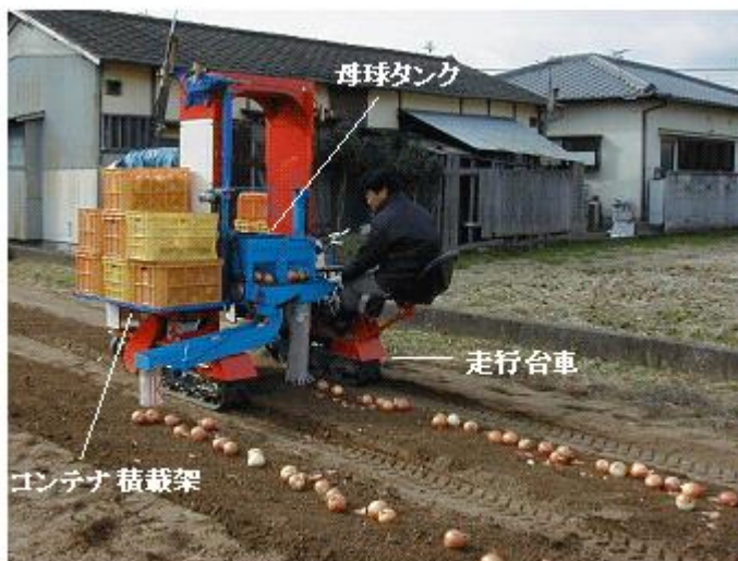
図1 母球配布機による作業状況
