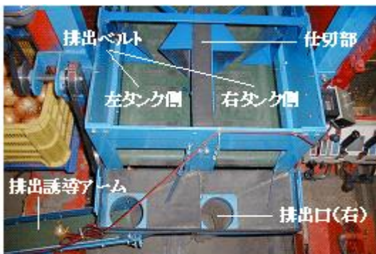
図2 母球排出部の構造
