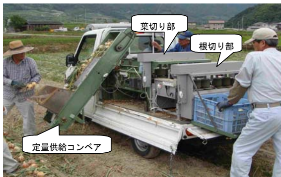
図1 開発した全自動根葉切り機と主要諸元(左図は移動利用時のようす)
