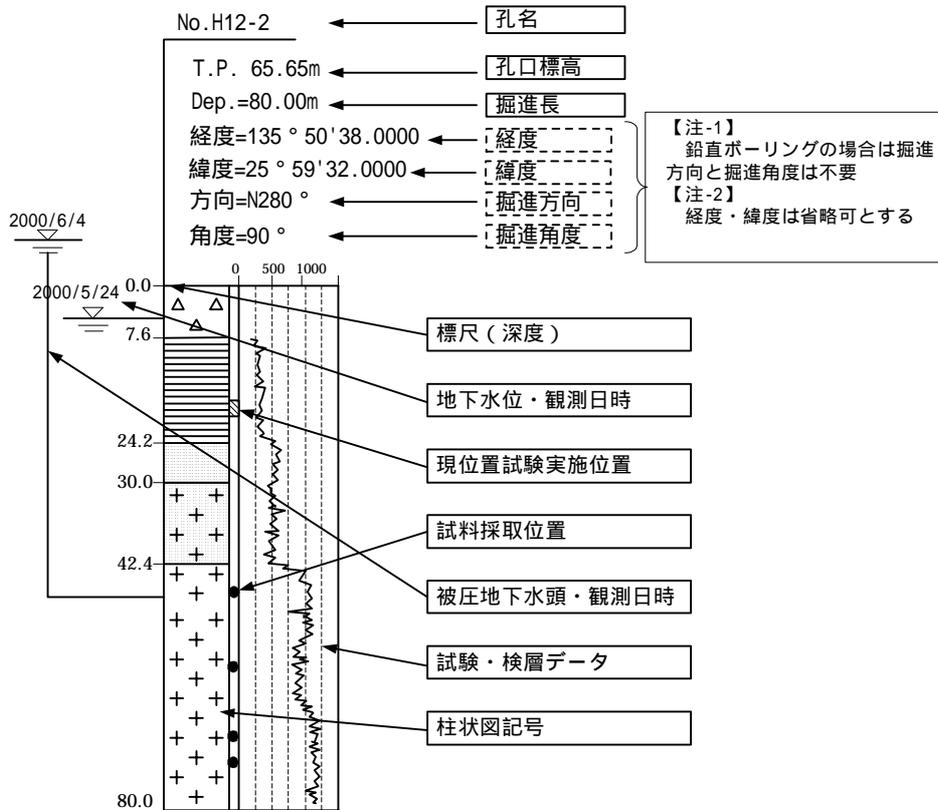
b)岩盤ボーリング簡略柱状図
