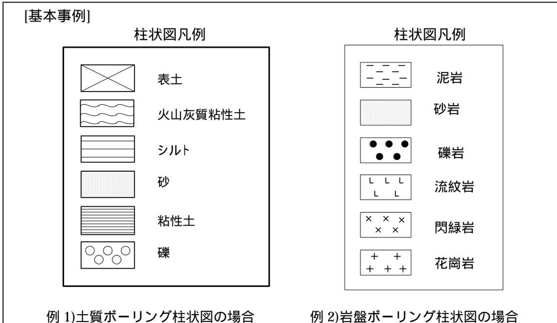
図 3-22 簡易柱状図の凡例の記載例
