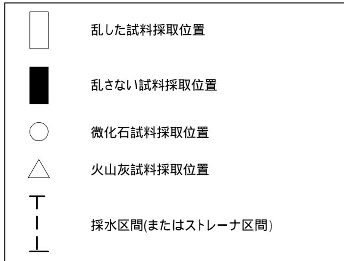
図 3-17 試料採取位置の凡例の記載例
