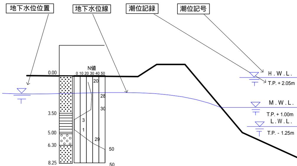
図 3-9 地下水面の記載例
