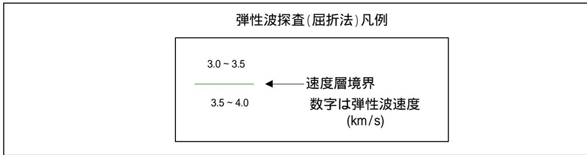
図 3-24 物理探査結果の凡例の記載例
