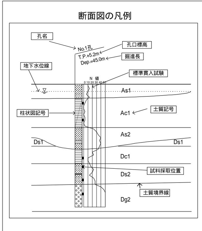
例 1)土質断面図の凡例の記載例
