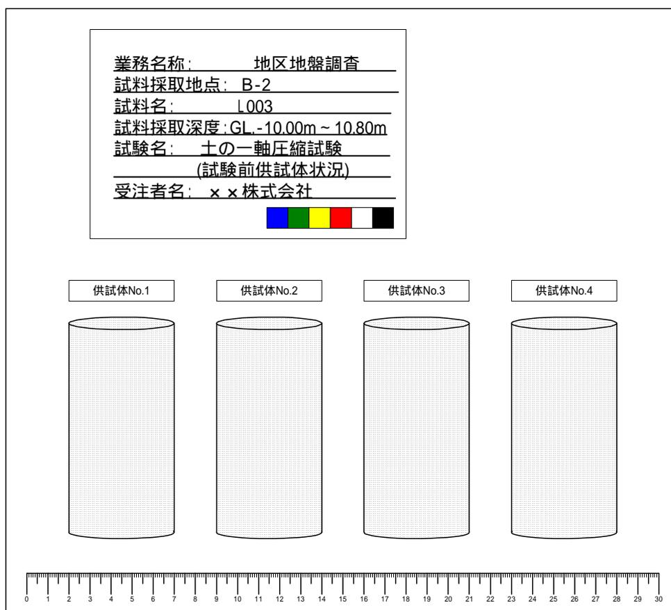
図 9-1 試料供試体写真の撮影例
