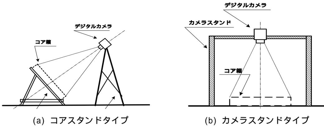
図 5-2 ボーリングコア写真の撮影方法例
