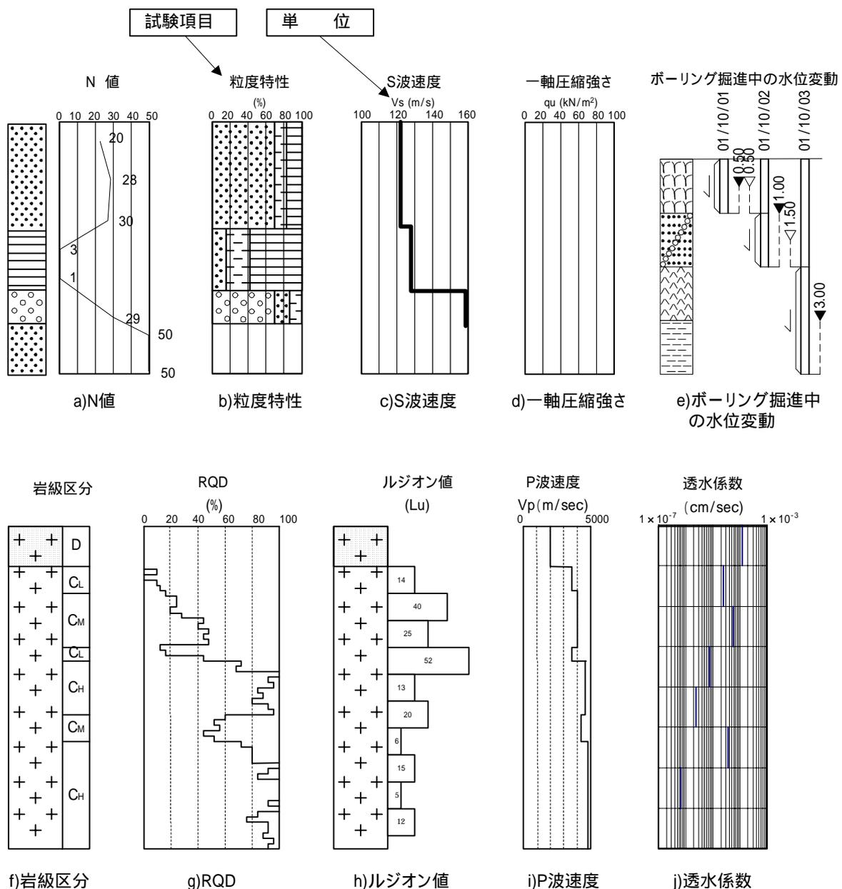
図 3-6 試験・検層データの記載例
