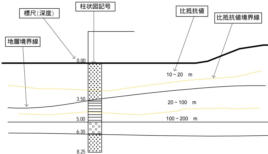
図 3-11 比抵抗断面図の記載例
