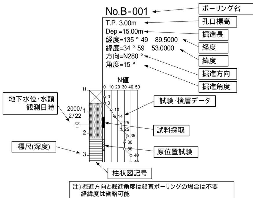
図 7-1 電子簡略柱状図の標準様式
