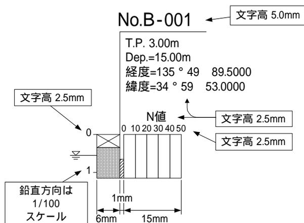
図 7-3 電子簡略柱状図の標準寸法
