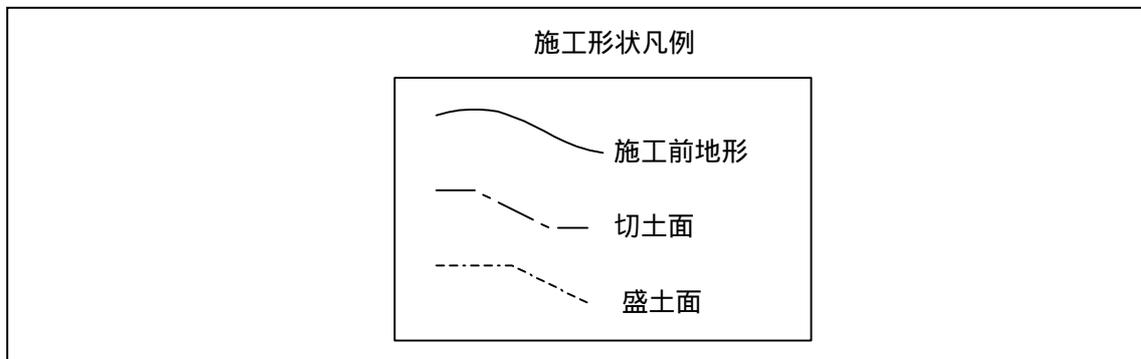
図 3-26 施工形状の凡例の記載例
