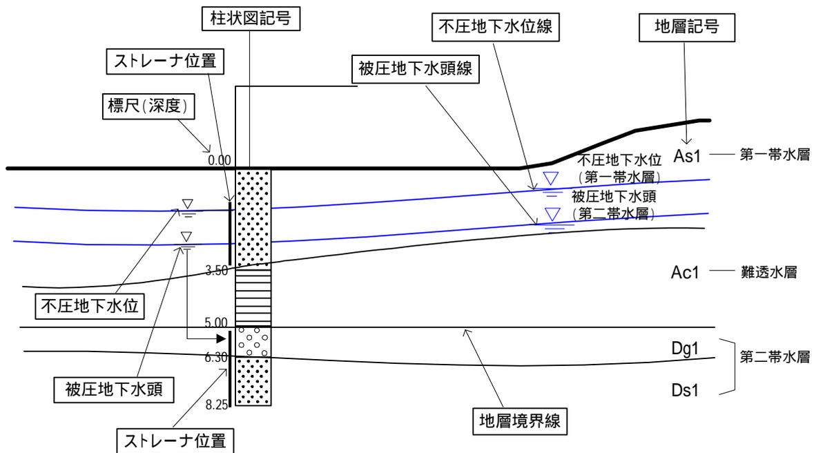
図 3-10 被圧地下水頭の記載例
