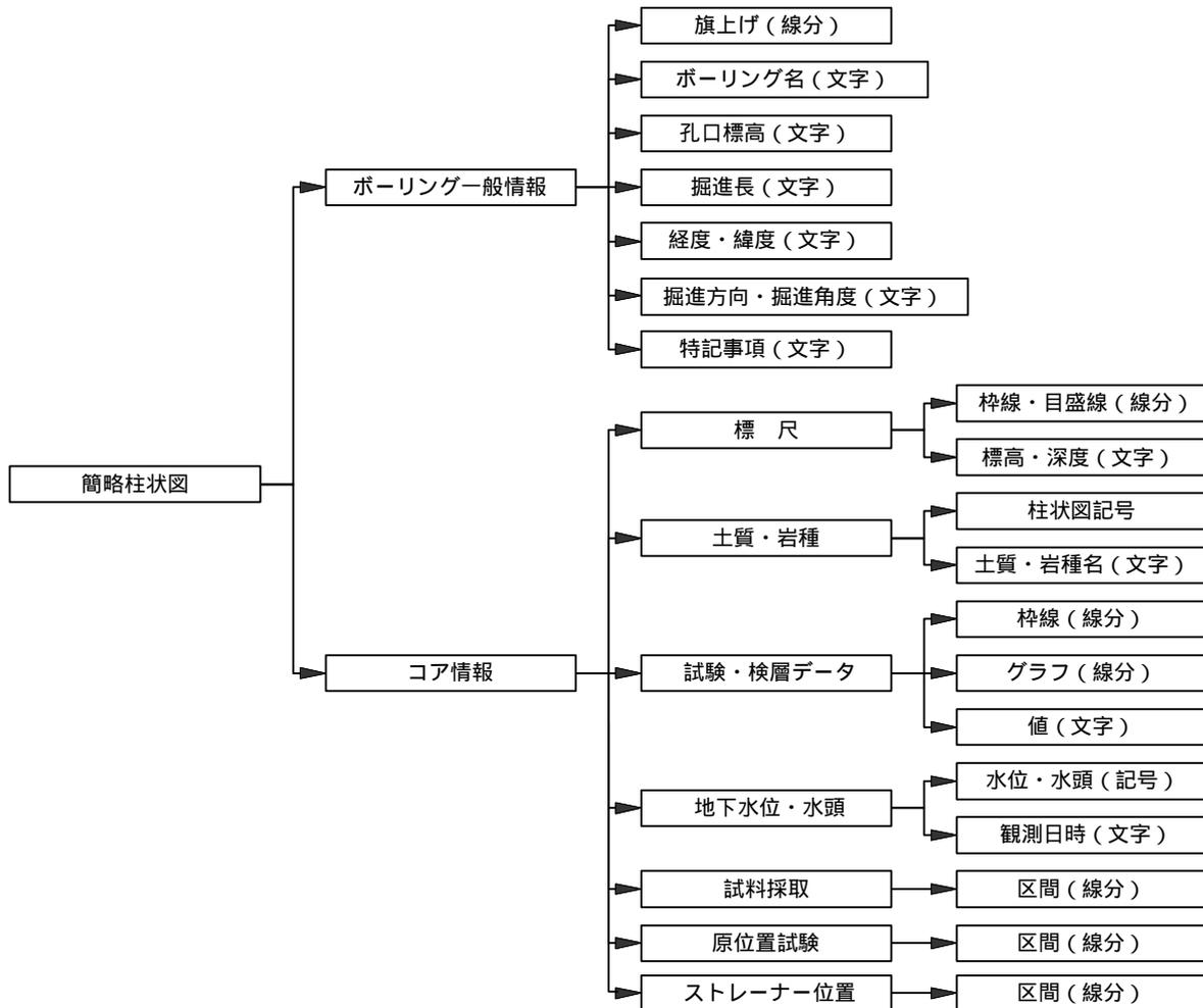
図 7-2 簡略柱状図の要素構成
