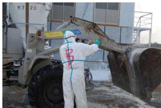
使用した重機の消毒
