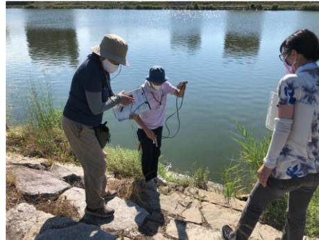
※春日川下流域 電気伝導度測定の様子
