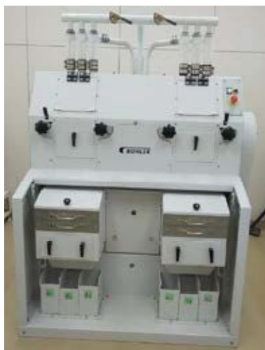
図9 大型試験製粉機 （ビューラーテストミル）
