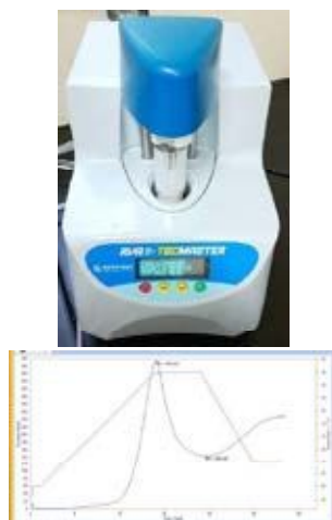
図10 ラピッド・ビスコ・ アナライザー （デンプンの特性を調査）
