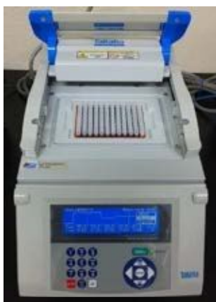
図12 サーマルサイクラー (遺伝子増幅装置)
