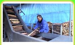
森林保全に役立つ間伐材を温泉の燃料として利用する(株)門入力メリアの取組みに注目。間伐された大きな木を薪にしてボイラーにくべる様子や、間伐の仕組みを分かりやすく紹介します。
