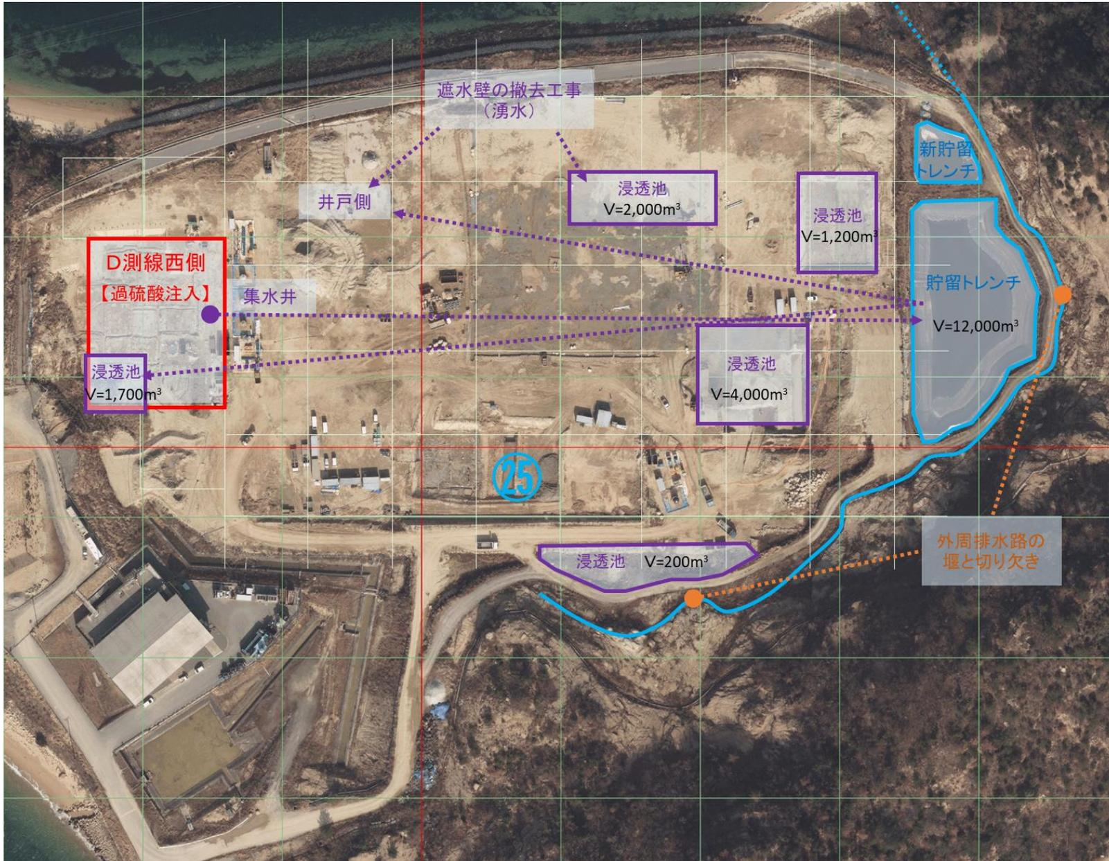
別図2 浸透池等の配置図 (撤去工事の実施時の例)
