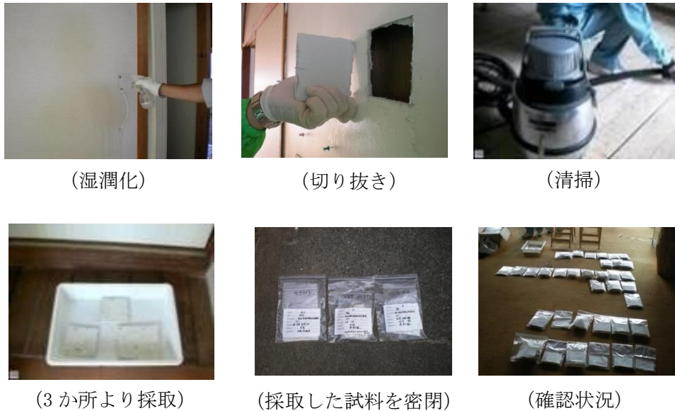
図 I - 5 - 8 サンプルング例 (成形板)
