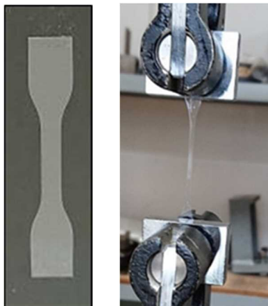
図3 試料片と引張試験の様子
