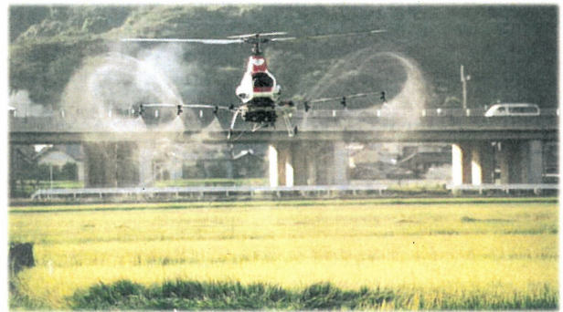
無人ヘリのダウンウォッシュ（プロペラの回転により生じる下側に吹き付ける風の強さ）
