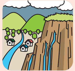
斜面から水が わき出る
