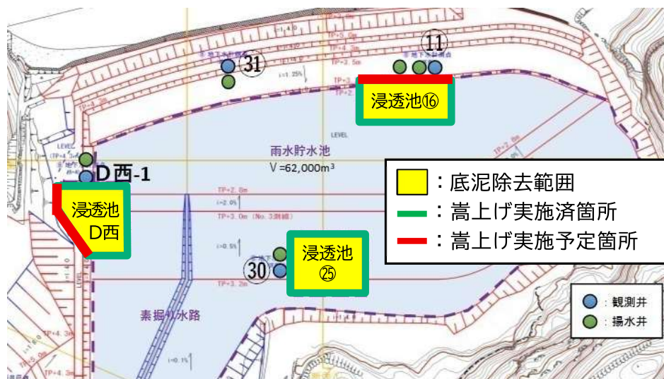
図1 底泥除去及び嵩上げ工事実施箇所
