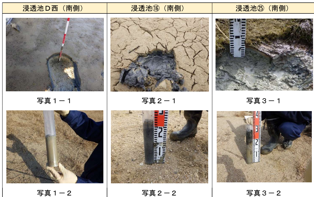
図2 各浸透池の採取土壌の状況（南側のみ）
