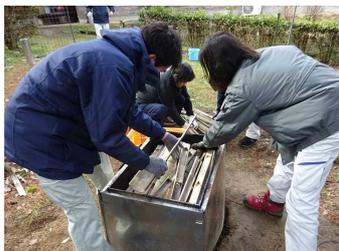
割った竹を簡易軽量炭化炉「簡単スミヤケル」に詰めます。炉内の温度の上がり方を考えて配置します。
