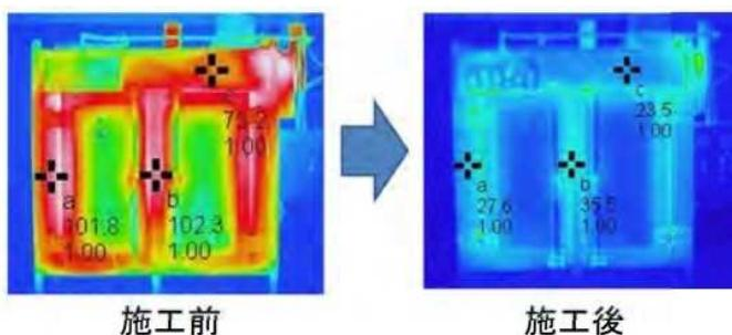
加熱中の電気炉表面の熱画像
