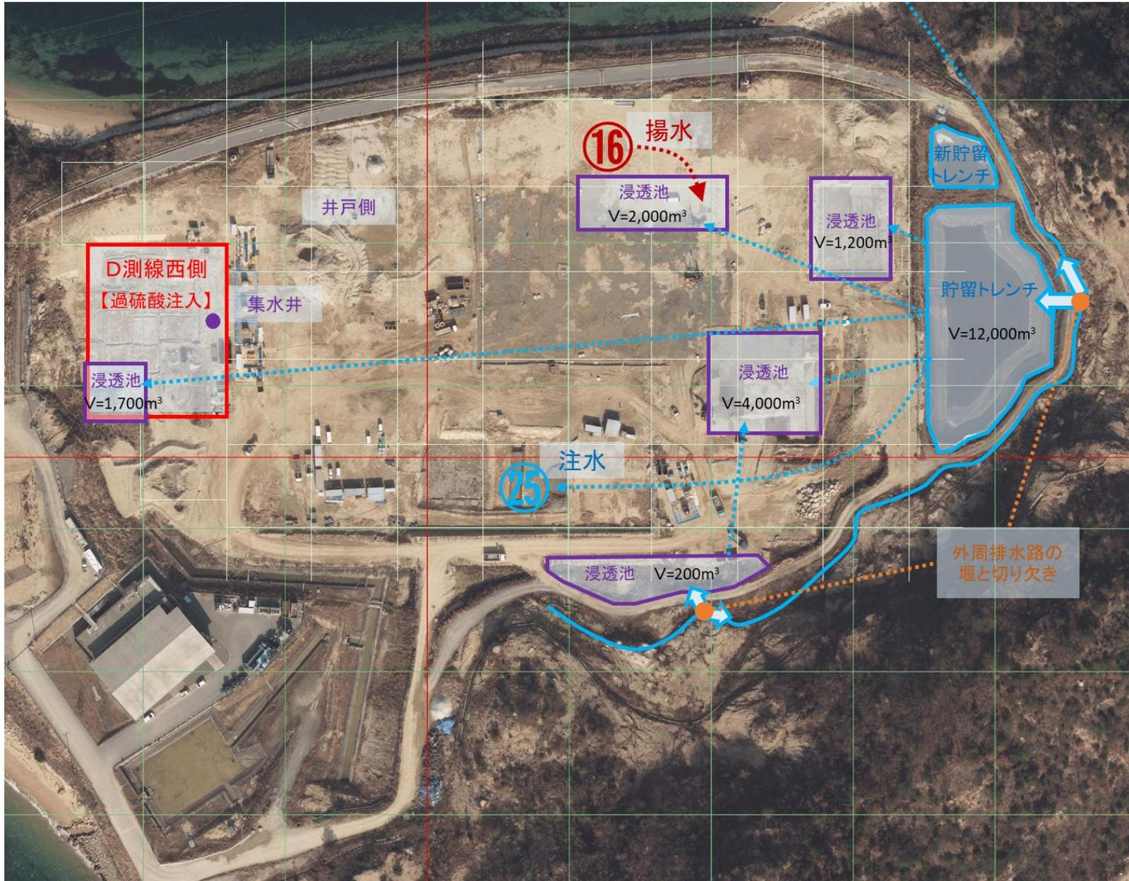
別図1 浸透池等の配置図（地下水浄化対策実施時の例）
