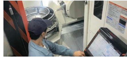
立形複合加工機での航空機エンジン部品の5軸加工
