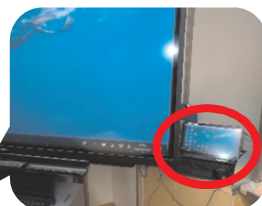
写真2 USB-HDMI カメラアダプタを使うことで、タブレットに電子黒板の画面をそのまま映すことが可能（教室前方 右に設置）
